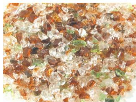
図表 13 スーパーソル製造プラントと小さな粒状にしたガラス
