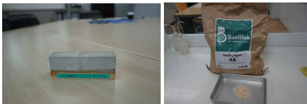
図表 15 ひび割れを自己治癒するコンクリート「Basilisk」
